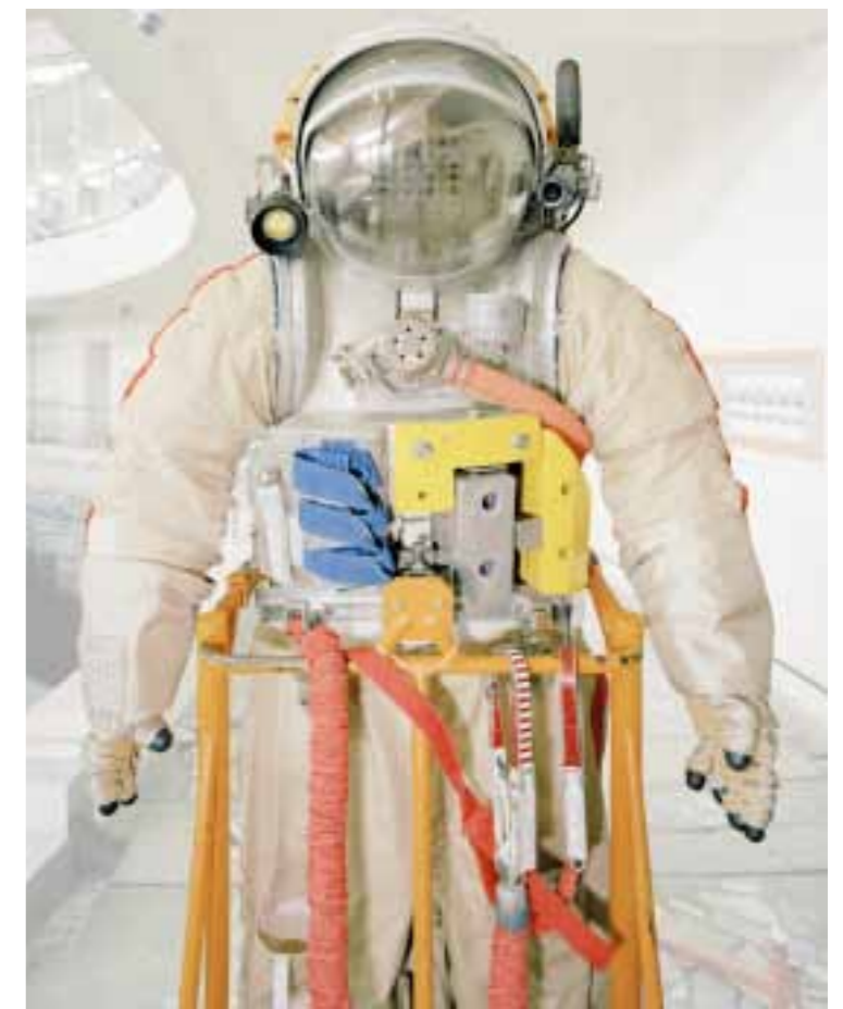
PRONTA PER IL TUFFO. Una tuta spaziale russa Orlan, nella versione utilizzata per la simulazione in piscina di attività extraveicolari nel corso del training a Star City (Russia).
